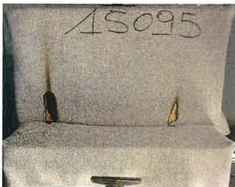
Il secondo innesco sulla provetta
