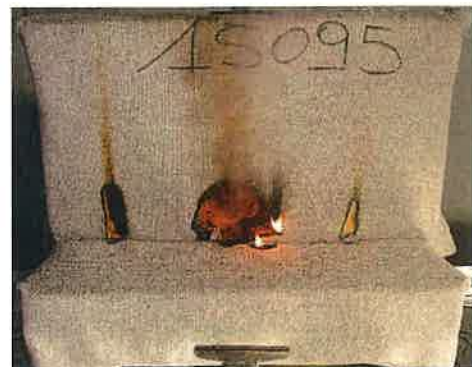
Il terzo innesco sulla provetta
