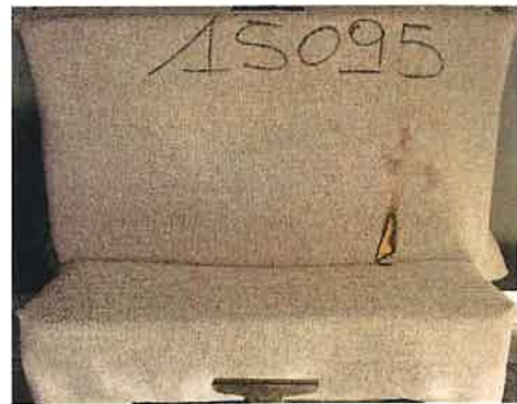
Il primo innesco sulla provetta
