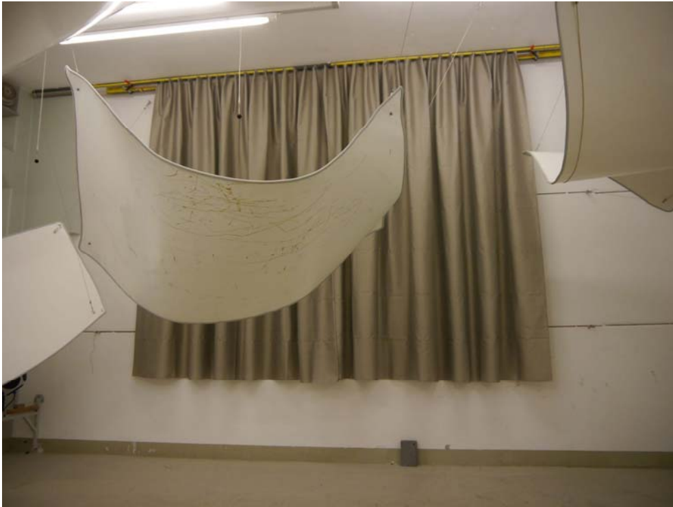
Abbildung B.3. Geraffte Anordnung, Prüfanordnung im Hallraum: Frontalansicht.
