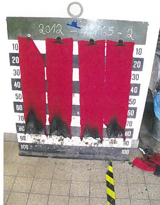
Aussehen der Probe B nach dem Brandschachtversuch
