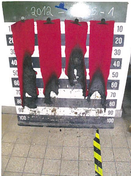
Aussehen der Probe A nach dem Brandschachtversuch
